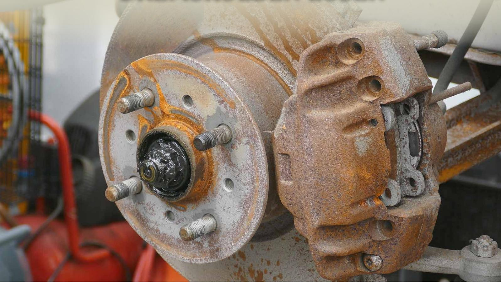
Nach langen Standzeiten kommt es nicht selten vor, dass die Bremskolben an den Scheibenbremsen fest sitzen. Dazu muss zuerst der Bremssattel abgenommen werden. Wenn die Bremskolben frei liegen, werden die Kolben zuerst mit einer Gasflamme erhitzt.
